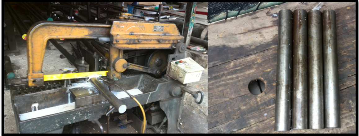
Figura 14: Dimensionamiento de las probetas de acero 1045 (2 in x 40 cm)
