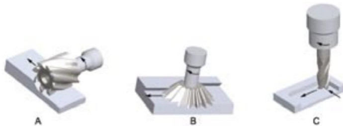
Figura 7. Operaciones básicas de fresado
