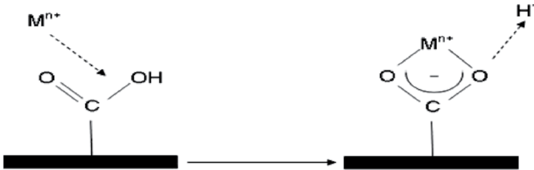
Figura 2. Mecanismo de intercambio catiónico con el grupo carboxílico de la superficie del carbón [10]. Figure 2. Cation exchange mechanism with the carboxylic group of the carbon surface [10].
