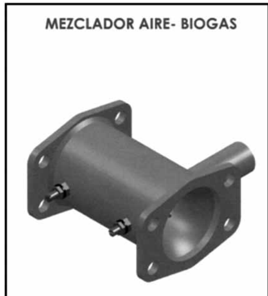
Figura 3. Dibujo isométrico del mezclador Figure 3. Isometric drawing of the mixer
