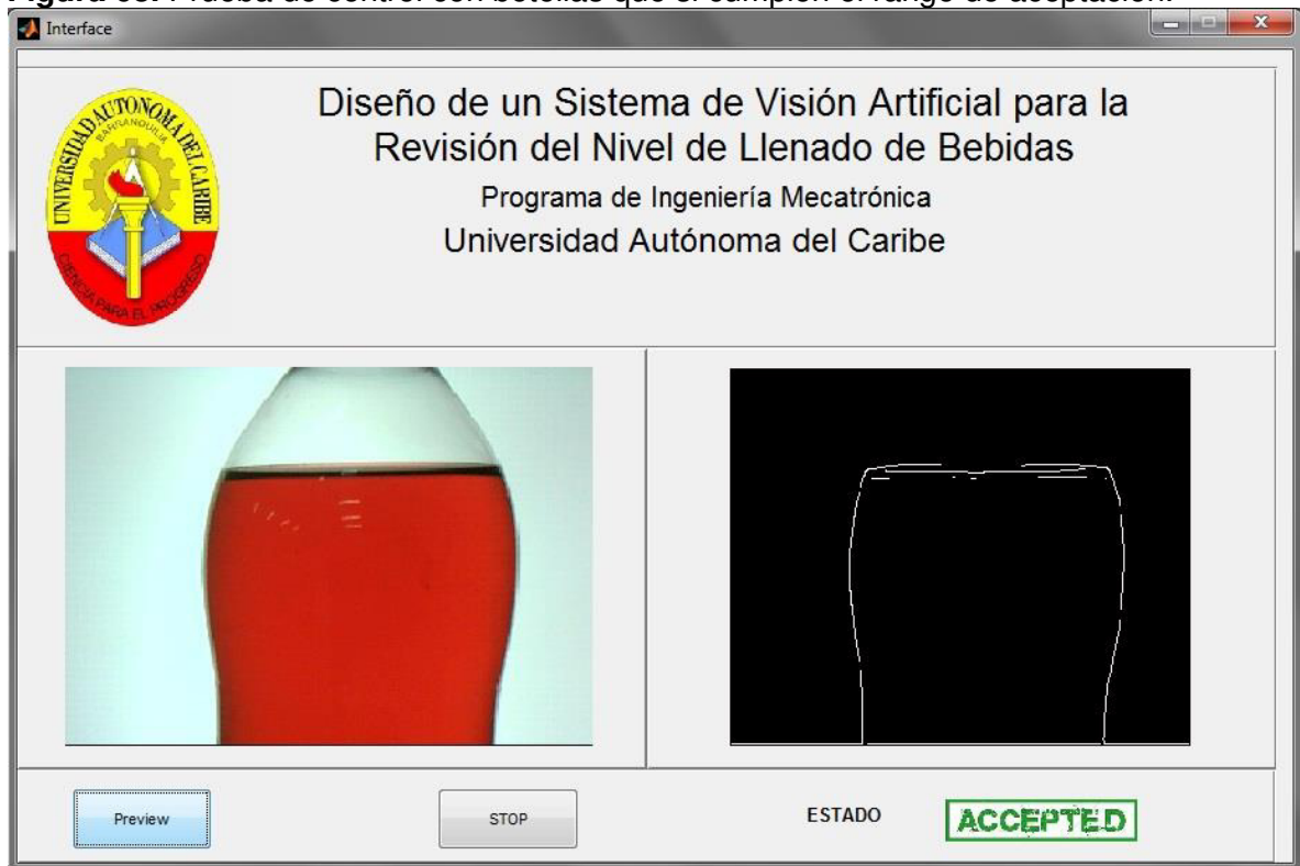
Figura 68. Prueba de control con botellas que si cumplen el rango de aceptación.
