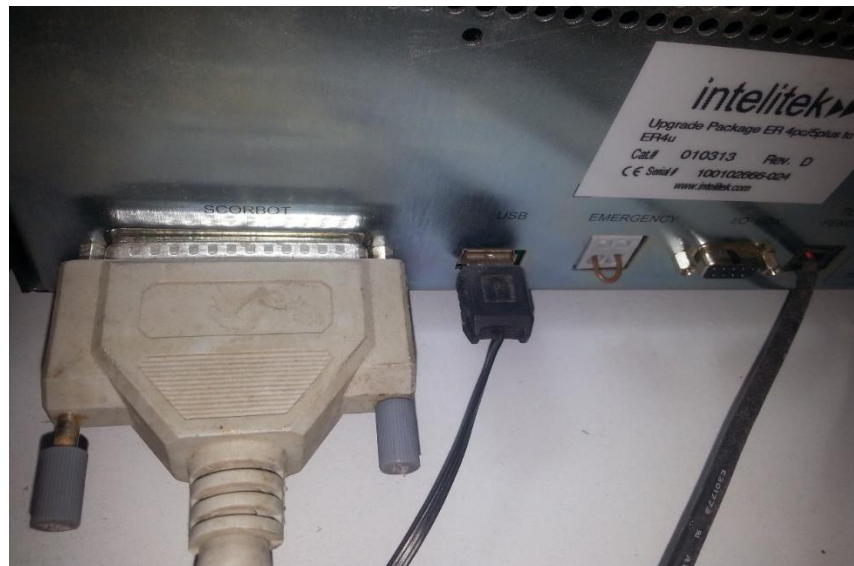
Figura 49. Conexión del SCORBOT al módulo controlador.
