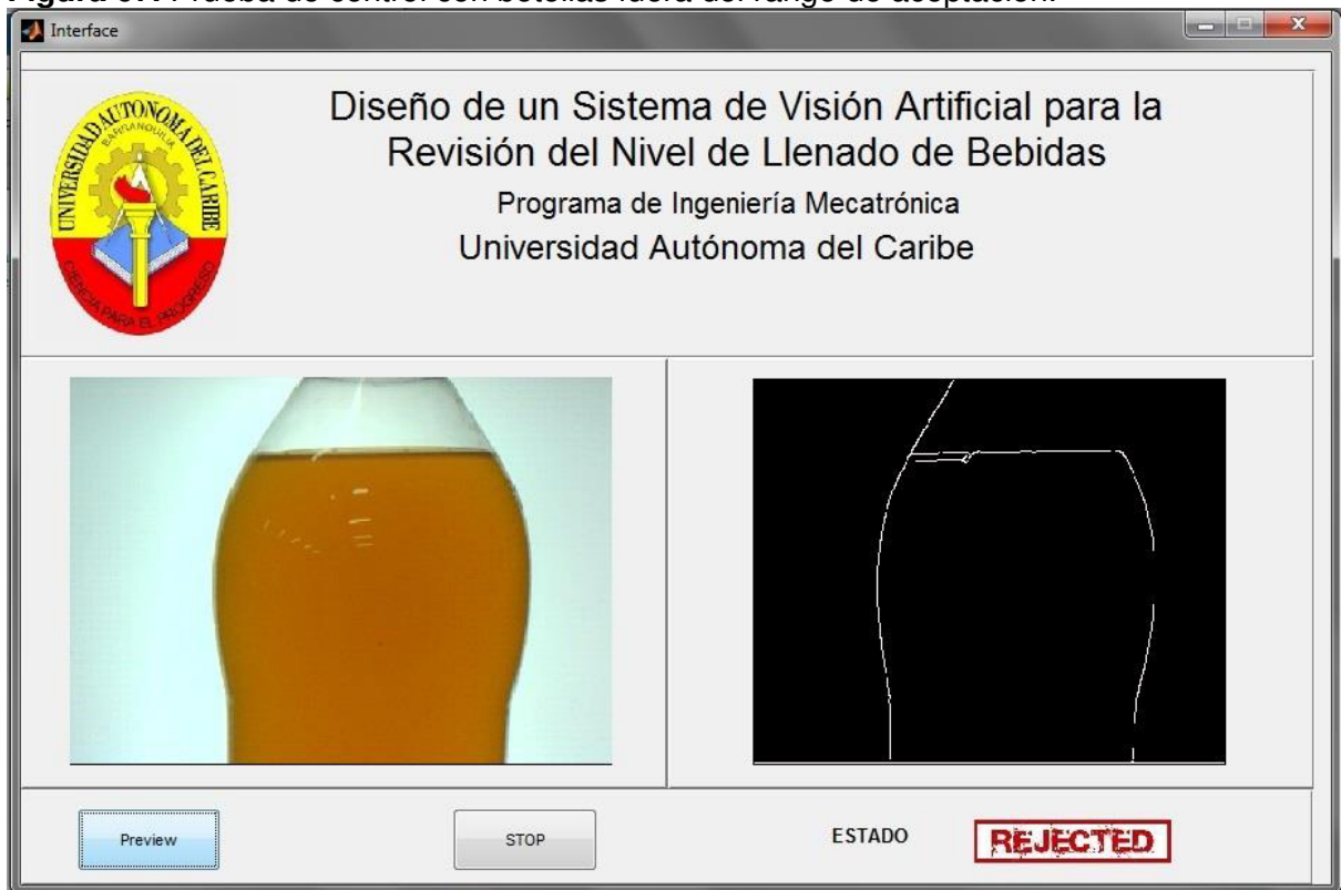
Figura 67. Prueba de control con botellas fuera del rango de aceptación.
