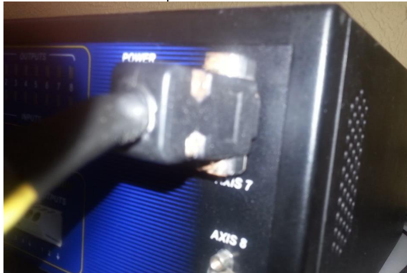
Figura 50. Conexión de la banda transportadora al módulo controlador.
