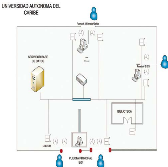
Figura 2. Modelo del prototipo de control de acceso a la Universidad Autónoma del Caribe
