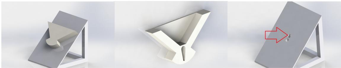
En la figura 21 se observa el dispositivo separador construido, el cual fue fabricado a través de impresión 3D. En la figura 22 el dispositivo extractor se encuentra posicionado al final de la banda, lugar donde recibe los frutos de café.
