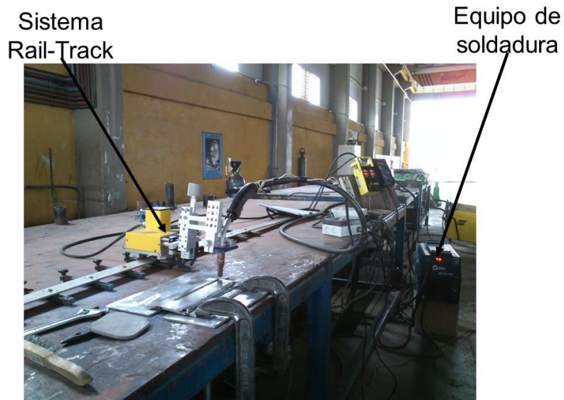
Figura 34 Montaje del experimento para el material base AA5083 H-116
