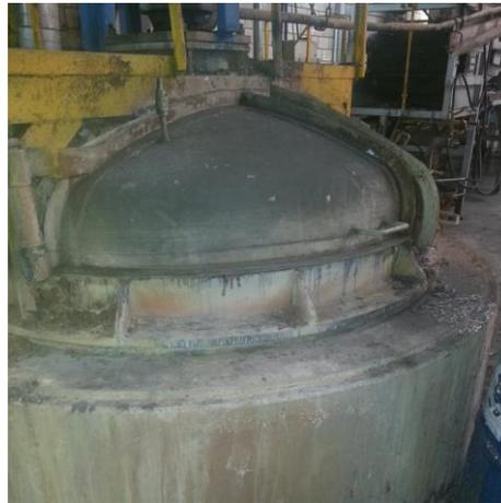
**Figura 2.1. Crisol de 30 toneladas para fundición y refinación de plomo**
