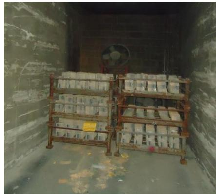
**Figura 2.6. Cuarto de secado con las rejillas empastadas y curadas en su interior**
