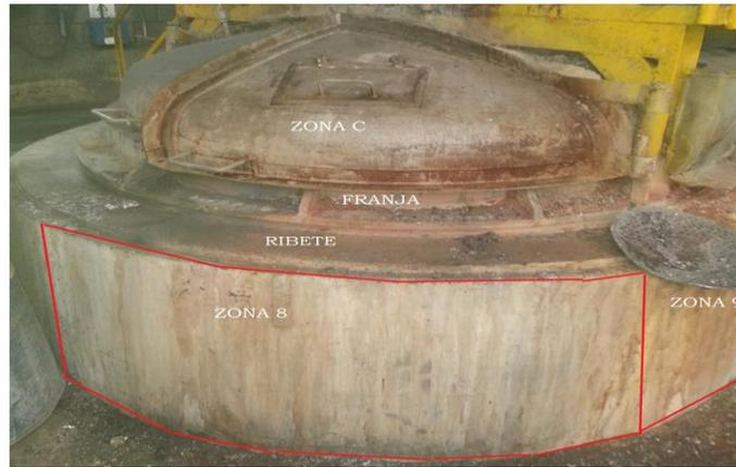
Figura 3.26. Horno de Metalurgia usado en la refinación de plomo.
