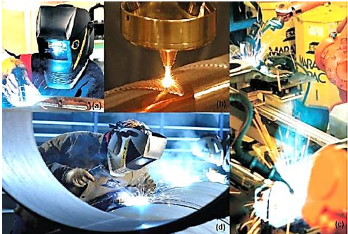
Figura 2. Distintas aplicaciones de procesos de soldadura. (a) Proceso de soldadura GMAW, (b) Proceso de soldadura por láser, (c) Proceso de soldadura por arco eléctrico automatizado y (d) Proceso de soldadura SMAW [22].
