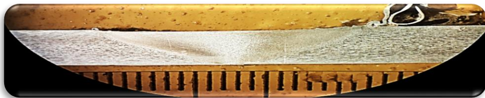
Figura 49. Gráfico de la zona agitada (nugget) obtenido para la soldadura por fricción-agitación con herramienta de hombro plano en maquina especializada en SFA.
