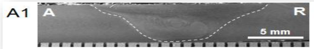
Figura 52. Forma de la zona agitada (nugget) obtenido para la soldadura por fricción-agitación con hombro plano en fresadora adaptada para SFA [29].
