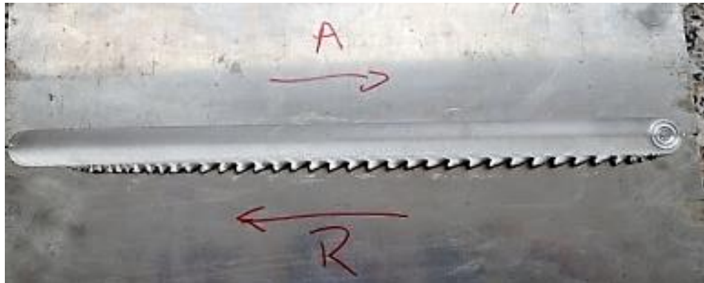
Figura 46. Cordón de soldadura con medición de temperatura hombro en espiral referencia 20130906.
