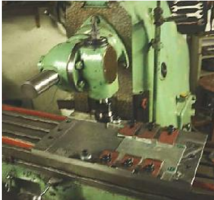
Figura 12. Distintos tipos de máquinas para desarrollar la soldadura por fricción-agitación [35].
