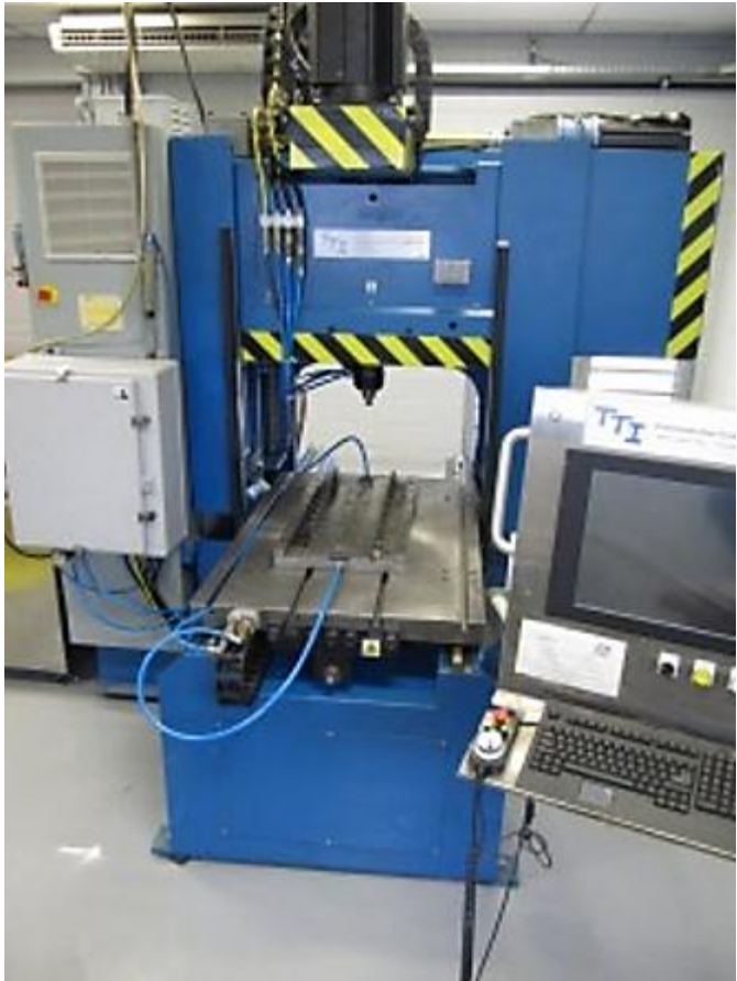
Figura 23. Máquina especializada para soldadura por fricción-agitación.
