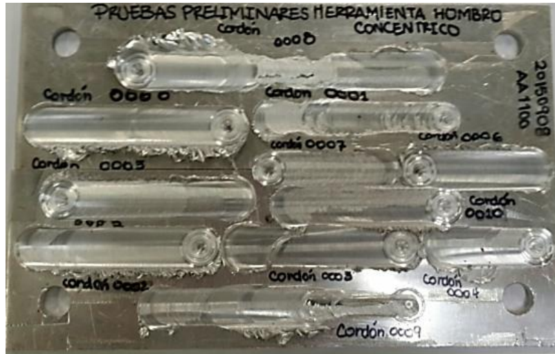
Figura 34. Cordones de soldadura obtenidos de las pruebas preliminares realizadas con la herramienta de hombro concéntrica en maquina especializada.
