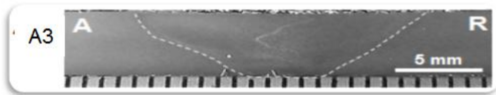
Figura 55. Gráfico de la zona agitada (nugget) obtenido para la soldadura por fricción-agitación con herramienta de hombro en espiral en fresadora adaptada.
