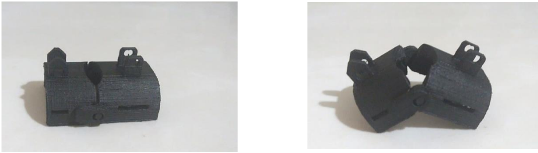
Figura 13. Piezas en sus dos estados para la flexión de los dedos
