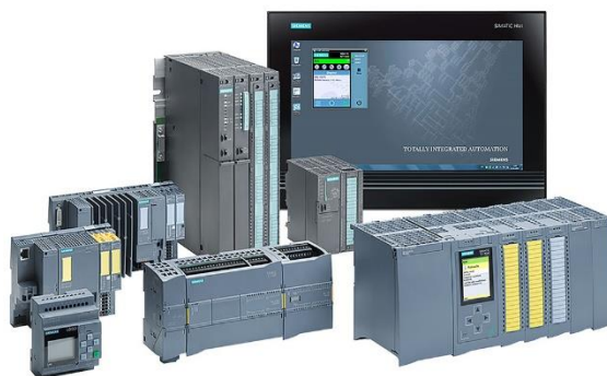
Figura 9. PLC en pequeñas dimensiones Fuente: versión tomada de fuente online disponible en Autycm [30].
