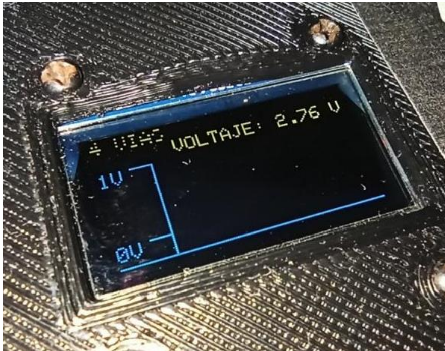
Figura 31. Prueba del sensor de 4 vías usado en mala condición [Los autores].
