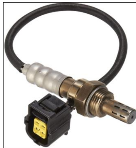
Figura 1. Sensor de oxígeno (O 2 ) [9].
