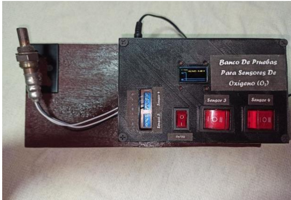
Figura 23. Vista superior del dispositivo final con un sensor a probar [Los autores].
