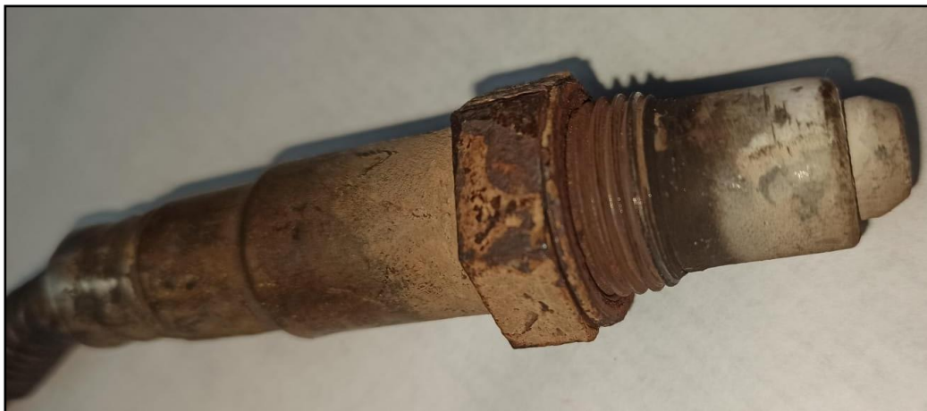
Figura 9. Sensor deteriorado [Los autores].
