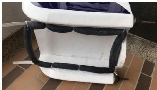
*Figura 19. Bolsas de aire agregadas en la base para mejor flotabilidad (propia autoría)*
