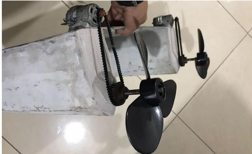
*Figura 14. Mecanismos de transmisión en aspas (propia autoría)*
