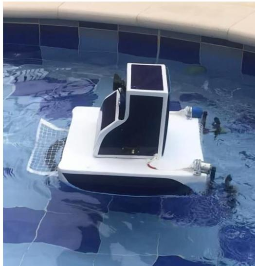
*Figura 21. Prueba de flotabilidad del USV (propia autoría)*
