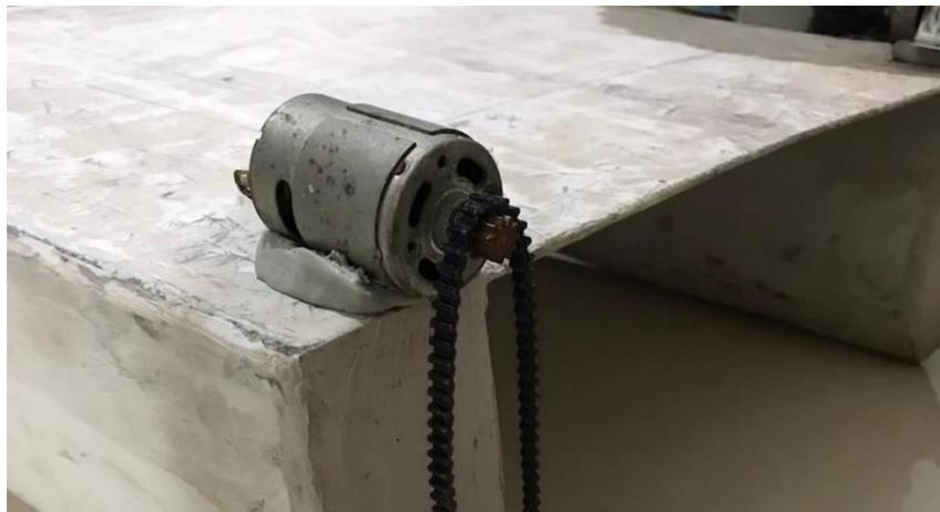
*Figura 13. Presentación de motores de propulsión (propia autoría)*
