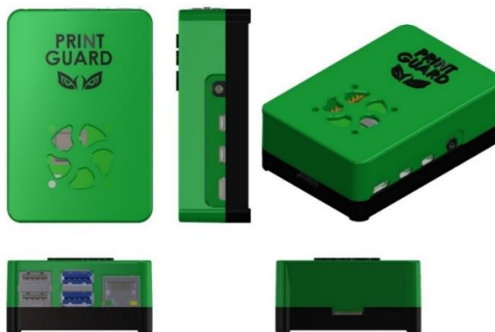
Figura 19. Ensamblaje CAD de Dispositivo PrintGuard (Autoría Propia)
