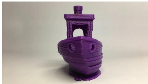
Figura 7. Ejemplo de LayerShifting [47]
