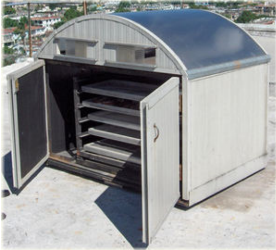
Figura 9. Sistema de secado solar.
