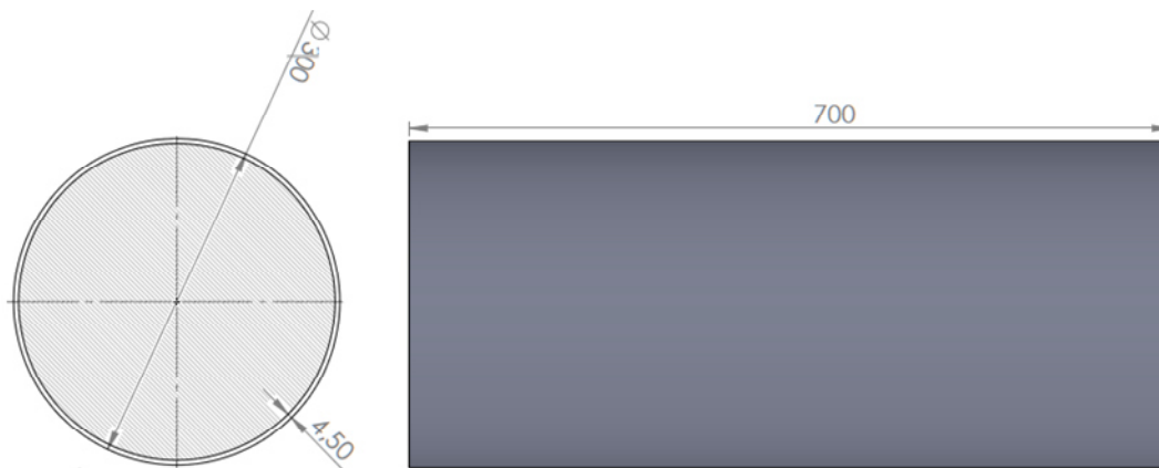
Figura 23. Dimensiones del tanque de lavado.
