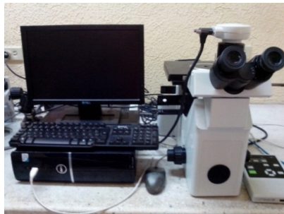
Figura 11. Microscopio metalográfico marca Olympus GX51. Vista frontal.
