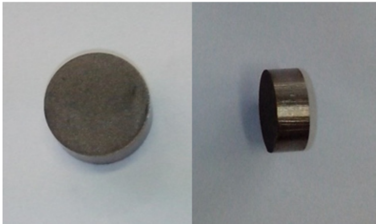
Figura 5: Muestras cortadas para realizar el tratamiento de oxidación térmica.
