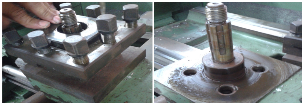
Figura 23. Desmontaje carcasa porta útil
