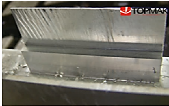
Figura 2. Marcas de chatter sobre paredes delgadas.
