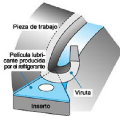
Figura 4. Acción del lubricante durante el mecanizado
